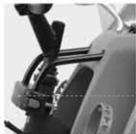
FF - ПЕРЕДНЯЯ СИСТЕМА МОНТАЖА НА РУЛЕВУЮ ТРУБУ
