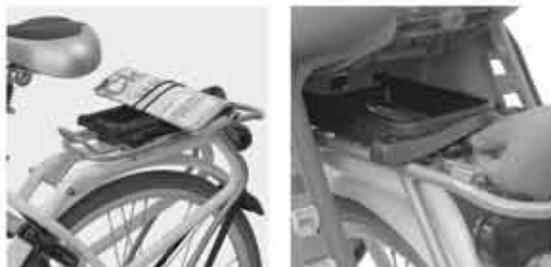
Держатель рамы позволяет установить / снять сиденье в считанные секунды, нажав на кнопку. Все инструменты и монтажный комплект необходимых для сборки сиденья в комплекте
