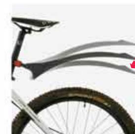
Регулировка по высоте подседельного штыря и выставление угла наклона.
