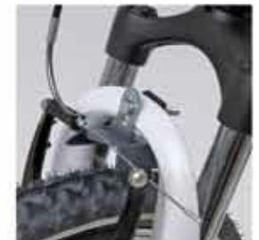
Вы можете снять/поставить крылья и оставить монтажные кронштейны на месте для быстрой установки всякий раз, когда вам это нужно.
