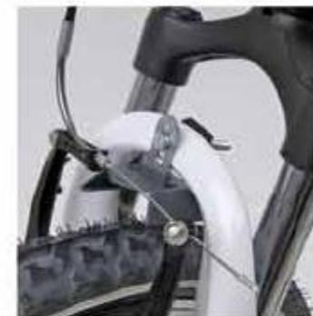
Вы можете снять и оставить монтажный крепеж на месте. И так же быстро поставить крыло обратно.
