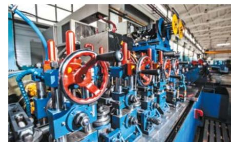
Собственное трубопрокатное производство для изготовления из листовой стали трубы различного диаметра. Формовочные станки позволяют придать трубе необходимую форму путем техноформинга, а также осуществить такие работы, как обжим, резка, вырубка и обсечка для максимально точной стыковки труб при сварке.
