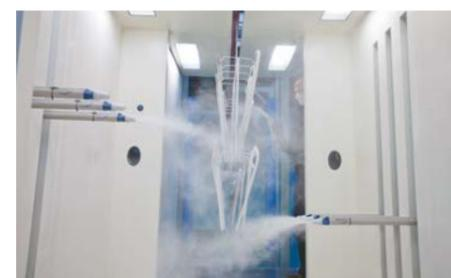
Покрасочный цех оборудован двумя автоматизированными линиями для нанесения краски. Первая — для порошковой окраски, на которой проходят этапы мойки, фосфотирования, сушки, нанесения краски, лака и запекания. Порошковое окрашивание дает минимальное количество отходов и позволяет снизить затраты на окрашивание даже небольших партий. Вторая линия — роботизированная линия покраски жидкими эмалями, на которой металл покрывается тремя слоями краски, слоем лака и высушивается до финального состояния.
