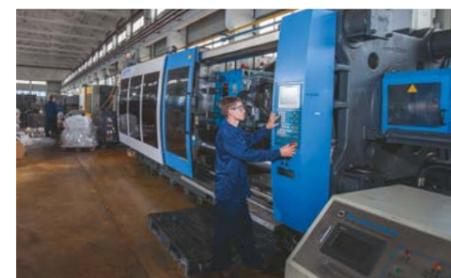
Современные станки с ЧПУ для литья деталей из пластмасс позволяют изготавливать широкий спектр пластиковых элементов от технологических заглушек до щитков цепей и колес любых цветов. Собственное оборудование позволяет расширить спектр производимых изделий и минимизировать затраты на их производство.
